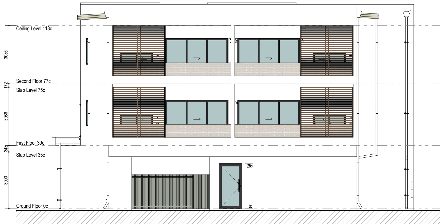
E3 East Elevation 1:100
